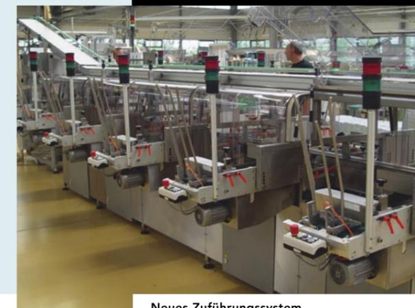
Neues Zuführungssystem mit 12 Magazinen / New feeding system with 12 magazines
