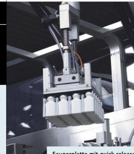
Saugerplatte mit quick release / Vacuum plate with quick release
