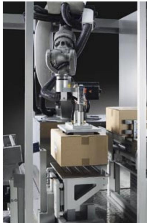
**Doppelte Sicherheit über scannen und wiegen – integriert im Palettierer von Pester**
